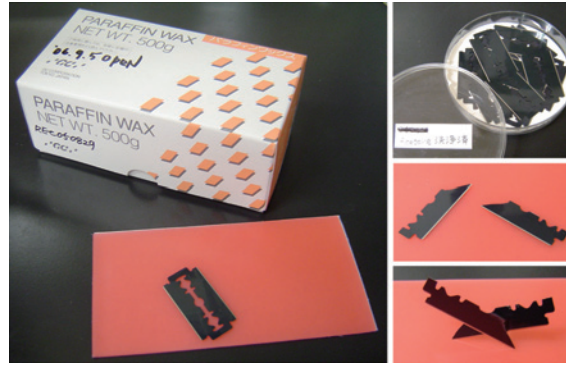
Fig. 1 デンタルワックス上での試料細切. アセトン洗浄した両刃のカミソリ刃 (埃が入らないように 100 mm 径培養皿に保管) を 2 つに折り, さらに片端を鋭角に折り, 細切用の刃, 2 枚を用意します. 2 枚の刃をすり合わせるよう (隙間を作らないように) 試料を薄く (少なくとも 2~3 ミリ厚に) スライスします. 押し切るのではなく, 引き切ります.
